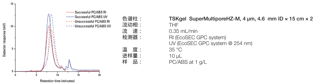
图3. 用RI（红）和UV（蓝）检测到的成功和失败的PC/ABS汽车部件的GPC谱图
