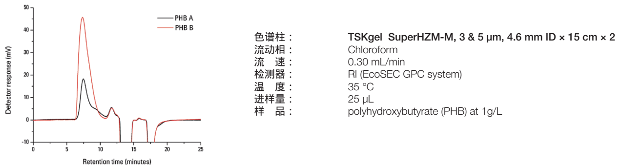
图4. 用RI检测到的外购PHB样品（PHB A）和自制PHB样品（PHB B）的GPC色谱图
