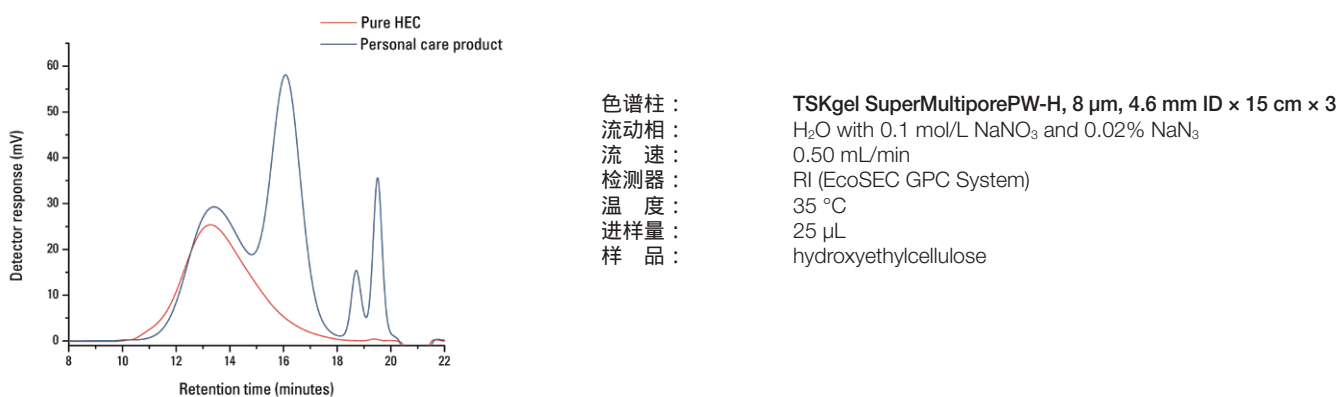
图15：HEC纯品（红）和个人洗护用品中的HEC（蓝）的GPC谱图
