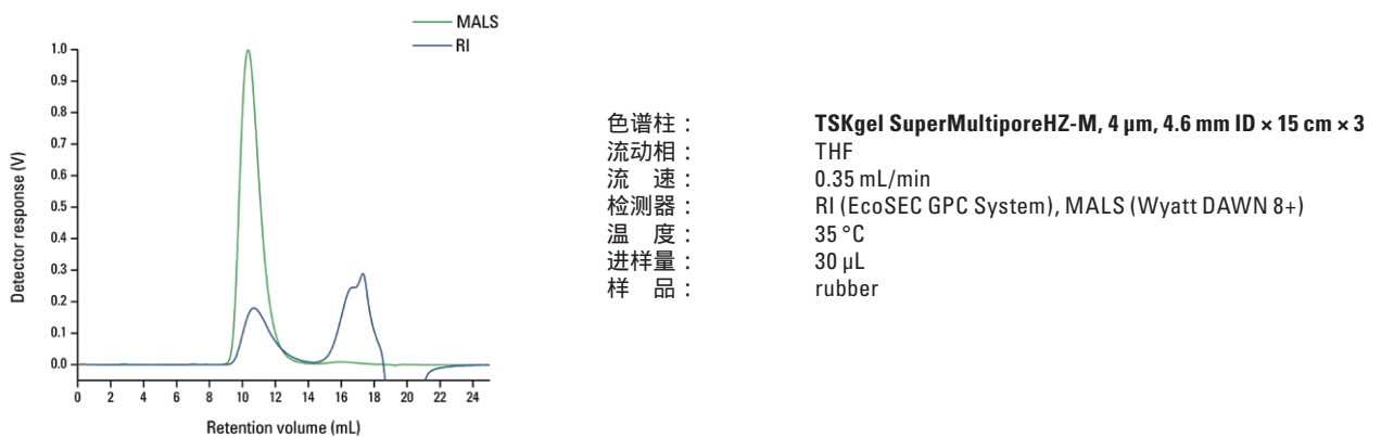
图14：使用RI（蓝）和MALS（绿）得到的橡胶样品的GPC谱图。
