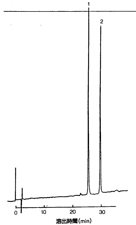
図-16 TSKgel ODS-80T M を用いたガストリン類の分離 溶離条件は図-1に同じ
